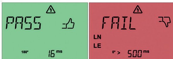
Rys. 53: Pomyślny pomiar RCD (po lewej) i niepomyślny pomiar (po prawej)
