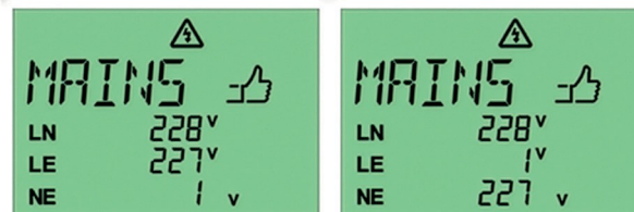
Rys. 10: Pomyślny wynik pomiaru, wartości pomiarowe mieszczą się w zakresie tolerancji
