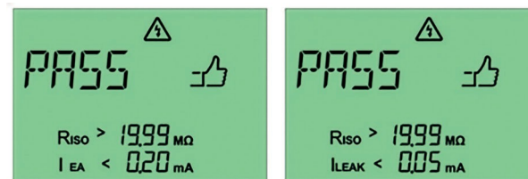
Rys. 36: Pomyślny pomiar metodą prądu upływowego zastępczego (po lewej) i metodą prądu różnicowego (po prawej) w urządzeniu o stopniu ochrony II
