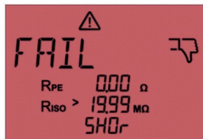
Rys. 48: Nieudany pomiar. Na wyświetlaczu pojawia się komunikat „SHOr”.
