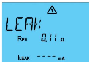
Rys. 59: Pomiar prądu przewodu ochronnego w urządzeniu 3-fazowym
