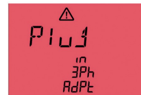
Rys. 62: Podłącz aktywny adapter pomiarowy 3-fazowy
