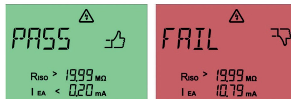
Rys. 35: Pomyślny pomiar prądu dotykowego (po lewej) i niepomyślny pomiar prądu dotykowego (po prawej) przy użyciu alternatywnej metody pomiaru prądu upływowego
