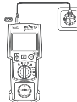
Rys. 9: Podłączenie urządzenia pomiarowego do zasilania
