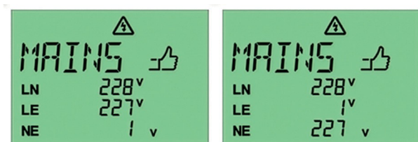
Rys. 10: Pomiar pozytywny, wartości pomiarowe mieszczące się w zakresie tolerancji
