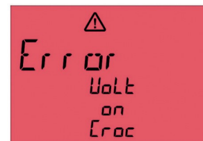
Rys. 61: Napięcie na metalowych częściach obiektu testowego
