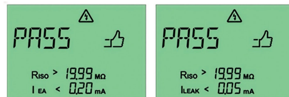
Rys. 36: Pomyślny pomiar metodą alternatywnego prądu upływowego (po lewej) i metodą prądu różnicowego (po prawej) dla urządzenia o stopniu ochrony II
