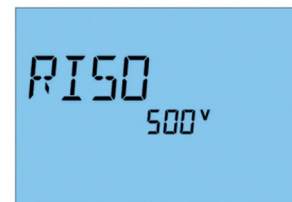
Rys. 4: Ustawianie napięcia pomiarowego R_{iso}
