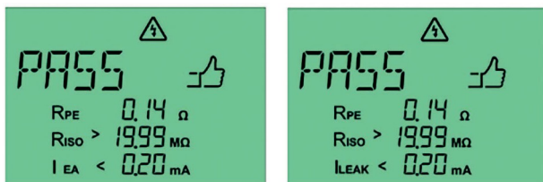
Rys. 26: Pomyślny wynik pomiaru metodą prądu upływowego zastępczego (po lewej) i metodą prądu różnicowego (po prawej) dla urządzenia o stopni? ochrony I
