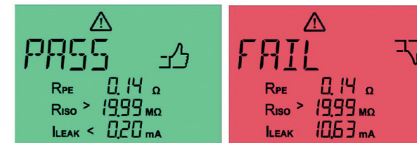
Abb. 24: Bestandene Schutzleiterstrommessung (links) und nicht bestandene Schutzleiterstrommessung (rechts)
