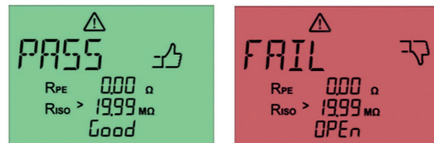
Abb. 49: Endergebnis einer bestandenen Leitungsprüfung (links) und einer nicht bestandenen Leitungsprüfung (rechts)
