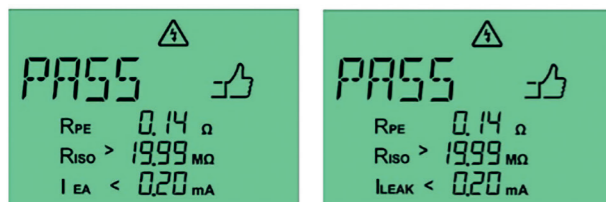
Abb. 26: Bestandene Messung mit dem Ersatzableitstromverfahren (links) und dem Differenzstromverfahren (rechts) bei einem Gerät der Schutzklasse I
