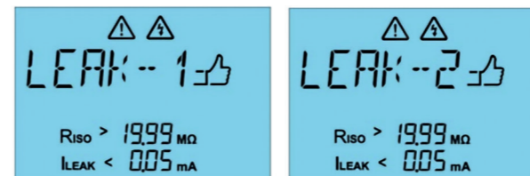
Abb. 32: Beidseitige Messung des Berührungsstroms
