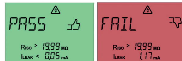
Abb. 33: Bestandene (links) und nicht bestandene Berührungsstrommessung (rechts)
