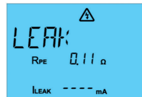
Abb. 59: Schutzleiterstrommessung bei einem 3-Phasen-Gerät
