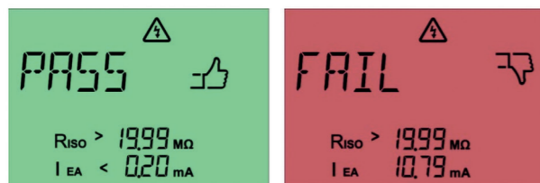
Abb. 35: Bestandene Berührungstrommessung (links) und nicht bestandene Berührungstrommessung (rechts) mit dem Ersatzableitstromverfahren
