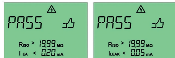
Abb. 36: Bestandene Messung mit dem Ersatzableitstromverfahren (links) und dem Differenzstromverfahren (rechts) bei einem Gerät der Schutzklasse II
