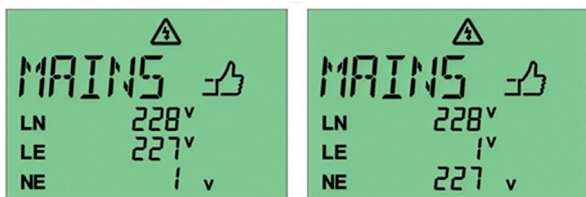
Fig. 10: Bestått måling, målte verdier innenfor toleranseområdet
