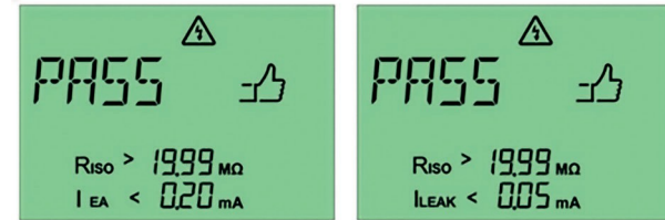
Fig. 36: Bestått måling med erstatningslekkasjestrømmetoden (til venstre) og differansestrømmetoden (til høyre) på et apparat i Kapselklasse II
