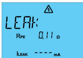
Fig. 59: Måling av beskyttelseslederstrøm i en 3-faset enhet
