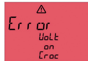
Fig. 61: Spenning på metalldele av testobjektet
