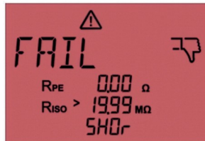
Fig. 48: Ikke bestått måling. Displayet viser «SHOr». Kortslutning mellom L og N
