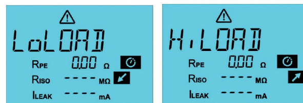
Fig. 19: LoLOAD (til venstre) og HiLOAD (til høyre)
