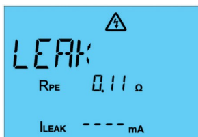
Fig. 59: Måling av jordingsstrøm på et 3-faset apparat
