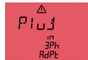
Fig. 62: Koble til aktiv 3-fase måleadapter
