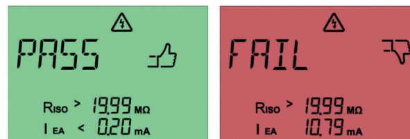
Fig. 35: Bestått berøringsstrømmåling (venstre) og ikke bestått berøringsstrømmåling (høyre) med den alternative lekkasjestrømmålingsmetoden
