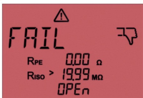
Fig. 47: Mislykket måling. «OPEN» vises på displayet. Ledertilkobling avbrutt/bryter åpen
