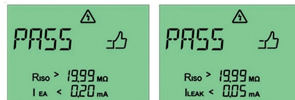
Fig. 36: Bestått måling med den alternative lekkasjestrømsmetoden (til venstre) og differensialstrømsmetoden (til høyre) for en enhet med beskyttelsesklasse II
