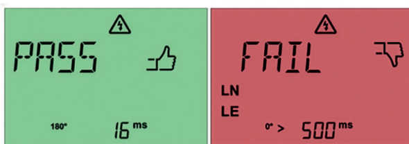
Fig. 53: Bestått RCD-måling (til venstre) og ikke bestått måling (til høyre)
