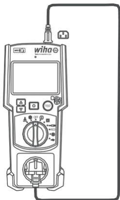
Fig. 38: Tilkobling av testobjektet til måleinstrumentet
