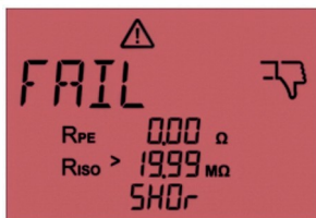
Fig. 48: Mislykket måling. «SHORT» vises på displayet. Kortslutning mellom L og N
