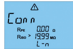
Kuva 45: Virtajohtimien liitännän tarkastus
