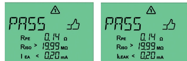
Kuva 26: Hyväksytty mittaus vaihtoehtoisella vuotovirta-menetelmällä (vasemmalla) ja differentiaalivirta-menetelmällä (oikealla) laitteelle, jonka suojausluokka on I.
