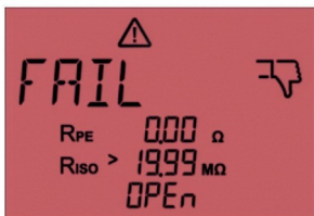
Kuva 47: Mittaus epäonnistui. Näytössä näkyy teksti "OPEN". Johtimen liitos katkennut/kytkin auki
