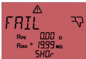
Kuva 48: Mittaus epäonnistui. Näytössä näkyy teksti "SHOr". Oikosulku L:n ja N:n välillä
