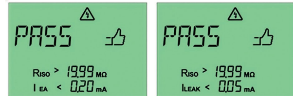
Kuva 36: Hyväksytyt mittaus vaihtoehtoisella vuotovirta-menetelmällä (vasemmalla) ja differentiaalivirta-menetelmällä (oikealla) laitteelle, jonka suojausluokka on II
