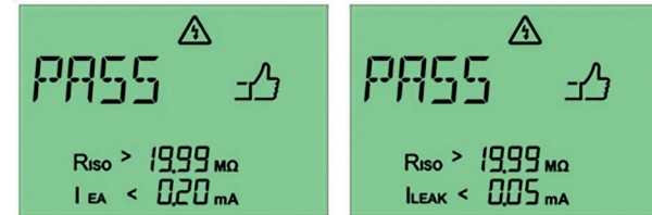
Kuva 36: Hyväksytty mittaus korvaavalla vuotovirta-menetelmällä (vasemmalla) ja erotusvirta-menetelmällä (oikealla) suojausluokan II laitteella
