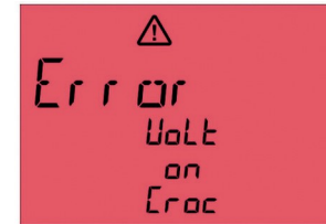
Kuva 61: Jännite testattavan laitteen metalliosissa
