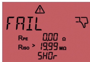
Kuva 48: Mittaus epäonnistui. Näytössä näkyy teksti "SHOR". Oikosulku L:n ja N:n välillä
