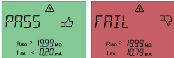
Kuva 35: Hyväksytty kosketusvirran mittaus (vasemmalla) ja hylätty kosketusvirran mittaus (oikealla) korvaavalla vuotovirta-menetelmällä
