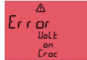
Kuva 61: Jännite testikohteen metalliosissa
