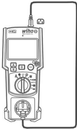
Kuva 38: Testikohteen liittäminen mittauslaitteeseen
