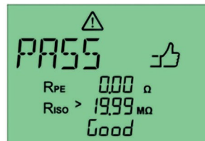
Kuva 49: Lopputulos hyväksytyistä johtotestistä (vasemmalla) ja hyläytyistä johtotestistä (oikealla)
