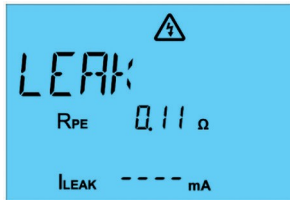
Kuva 59: Suojajohtimen virran mittausta 3-vaiheisessa laitteessa
