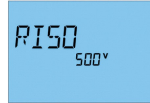
Kuva 4: Mittausjännitteen R_{ISO} asettaminen
