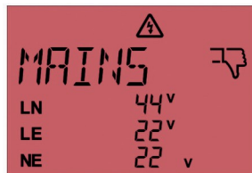
Kuva 11: Eponnistunut mittaus, mitatut arvot toleranssialueen ulkopuolella
