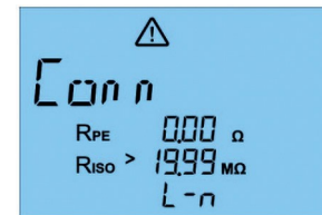
Kuva 45: Tarkista virtaa johtavien johtimien liitäntä
