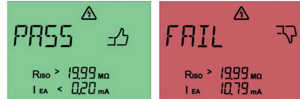
Kuva 35: Hyväksytyt kosketusvirran mittaus (vasemmalla) ja hylätty kosketusvirran mittaus (oikealla) vaihtoehtoisella vuotovirta-menetelmällä
