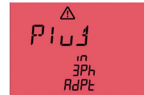
Kuva 62: Aktiivisen 3-vaiheisen mittausadapterin liittäminen
