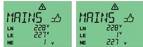
Kuva 10: Mittaus onnistui, mittausarvot ovat toleranssialueella
