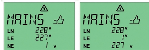
Kuva 10: Hyvasytty mittaus, mittauserot toleranssialueella
