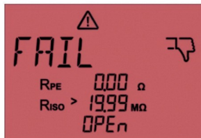
Kuva 47: Mittaus epäonnistui. Näytössä näkyy teksti "OPEN". Johtimen liitos katkennut/kytkin auki
