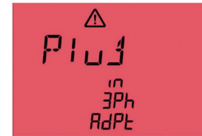
Kuva 62: Kytke aktiivinen 3-vaiheinen mittaussovitin
