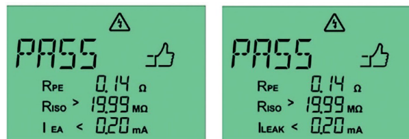
Afb. 26: Geslaagde meting met de alternatieve lekstroommethode (links) en de differentiaalstroommethode (rechts) voor een apparaat met beschermingsklasse I
