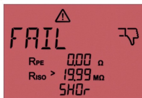
Afb. 48: Meting niet geslaagd. Op het display wordt "SHOr" weergegeven. Kortsluiting tussen L en N
