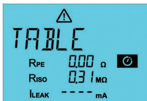
Afb. 21: Meting onderbroken; meetwaarde controleren en meting indien nodig voortzetten of afbreken
