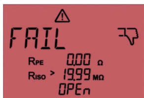
Afb. 47: Meting mislukt. Op het display wordt 'OPEn' weergegeven. Geleiderverbinding onderbroken/schakelaar open
