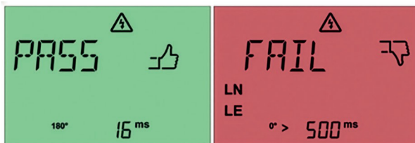
Afb. 53: Geslaagde RCD-meting (links) en niet-geslaagde meting (rechts)
