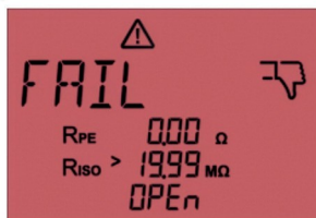
Afb. 47: Meting niet geslaagd. Op het display wordt "OPEN" weergegeven. Leiderverbinding onderbroken/schakelaar geopend
