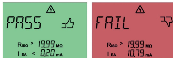
Afb. 35: Geslaagde aanraakstroommeting (links) en mislukte aanraakstroommeting (rechts) met de alternatieve lekstroommethode
