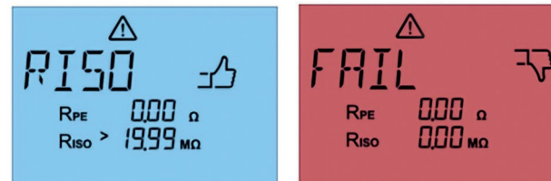
Afb. 44: Geslaagde meting van isolatieweerstand (links) en mislukte meting (rechts)
