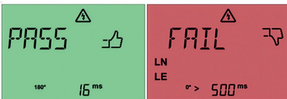
Afb. 53: Geslaagde RCD-meting (links) en mislukte meting (rechts)
