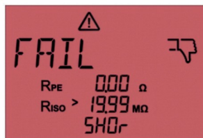
Afb. 48: Mislukte meting. Op het display wordt 'SHOr' weergegeven. Kortsluiting tussen L en N
