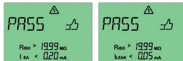
Afb. 36: Geslaagde meting met de vervangende lekstroommethode (links) en de differentiaalstroommethode (rechts) bij een apparaat met een Beschermingsgraad II
