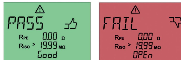
Afb. 49: Eindresultaat van een geslaagde leidingcontrole (links) en een niet-geslaagde leidingcontrole (rechts)
