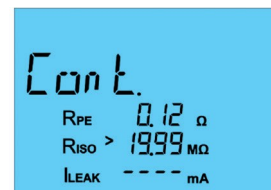
Fig. 25: Kontinuerlig mätning (Cont. läge)
