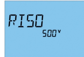
Fig. 4: Inställning av mätspänningen R_{50}
