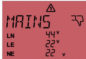
Fig. 11: Misslyckad mätning, mätvärden utanför toleransområdet
