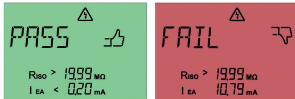
Fig. 35: Godkänd beröringsströmsmätning (vänster) och underkänd beröringsströmsmätning (höger) med ersättningsläckströmmetoden
