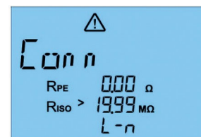
Fig. 45: Kontrollera anslutningen av de strömförande ledarna
