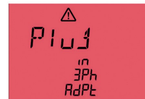
Fig. 62: Anslut aktiv 3-fas mätadapter
