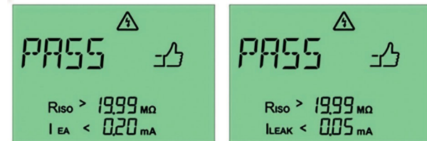
Fig. 36: Godkänd mätning med den alternativa läckströmmetoden (vänster) och differentialströmmetoden (höger) för en enhet med skyddsklass II
