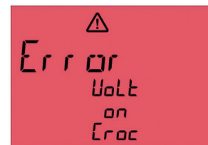
Fig. 61: Spänning på metalldelar på testobjektet
