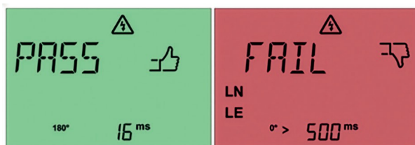
Fig. 53: Godkänd RCD-mätning (vänster) och underkänd mätning (höger)
