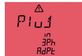
Fig. 62: Anslut den aktiva 3-fas-mätadaptorn
