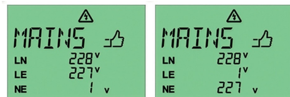
Fig. 10: Godkänd mätning, mätvärden inom toleransområdet
