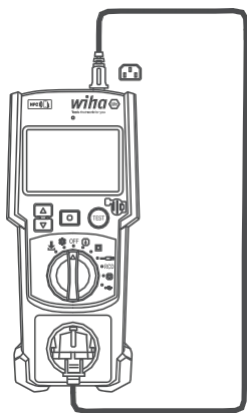
Fig. 38: Anslutning av testobjektet till mätanordningen
