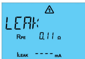
Fig. 59: Mätning av skyddsledarström i en 3-fasenhet
