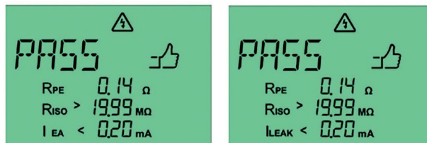
Fig. 26: Godkänd mätning med ersättningsläckströmmetoden (till vänster) och differensströmmetoden (till höger) på en apparat i skyddsklass I
