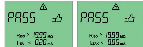
Fig. 36: Godkänd mätning med ersättningsläckströmmetoden (till vänster) och differensströmmetoden (till höger) på en enhet i skyddsklass II
