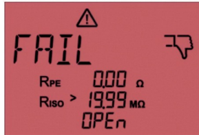
Fig. 47: Misslyckad mätning. Displayen visar "OPEN". Ledarkoppling avbruten/brytare öppen
