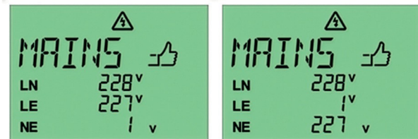
Fig. 10: Godkänd mätning, mätvärden inom toleransområdet
