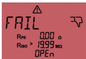
Fig. 47: Medición fallida. En la pantalla aparece «OPEN». Conexión del conductor interrumpida/interruptor abierto
