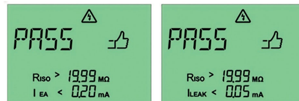
Fig. 36: Medición superada con el método de corriente de fuga sustitutiva (izquierda) y el método de corriente diferencial (derecha) en un dispositivo de clase de protección II
