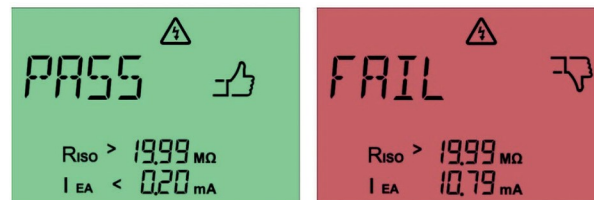
Fig. 35: Medición de corriente de contacto superada (izquierda) y medición de corriente de contacto fallida (derecha) con el método de corriente de fuga alternativa
