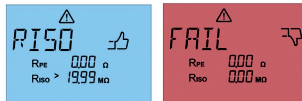
Fig. 44: Medición superada de la resistencia de aislamiento (izquierda) y medición fallida (derecha)
