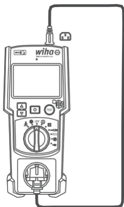
Fig. 38: Conexión del objeto de prueba al dispositivo de medición
