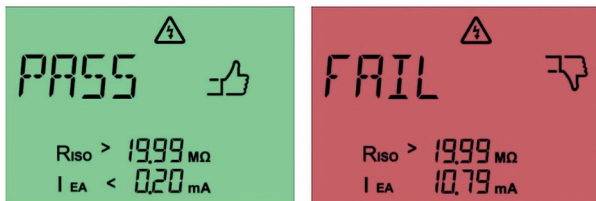
Fig. 35: Medición de corriente de contacto superada (izquierda) y medición de corriente de contacto no superada (derecha) con el método de corriente de fuga sustitutiva
