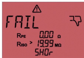
Fig. 48: Medición fallida. En la pantalla aparece «SHOR». Cortocircuito entre L y N
