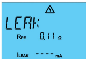
Fig. 59: Medición de la corriente del conductor de protección en un dispositivo trifásico
