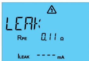
Fig. 59: Medición de la corriente del conductor de protección en un dispositivo trifásico
