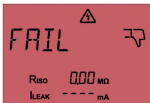
Fig. 31: Prueba de aislamiento no superada
