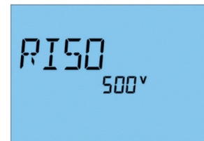
Fig. 4: Ajuste de la tensión de medición R_{so}
