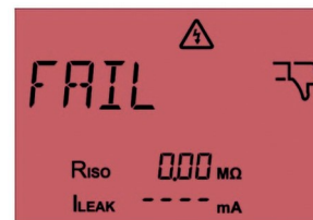
Fig. 31: Prueba de aislamiento fallida
