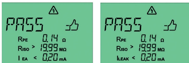
Fig. 26: Medición superada con el método de corriente de fuga sustitutiva (izquierda) y el método de corriente diferencial (derecha) en un aparato de clase de protección I
