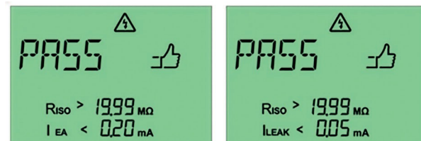
Fig. 36: Medición aprobada con el método alternativo de corriente de fuga (izquierda) y el método de corriente diferencial (derecha) para un dispositivo con índice de protección II
