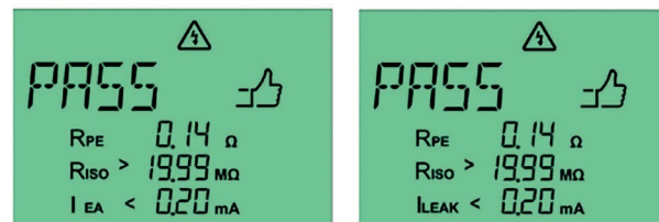
Fig. 26: Medición superada con el método alternativo de corriente de fuga (izquierda) y el método de corriente diferencial (derecha) para un dispositivo con grado de protección I.
