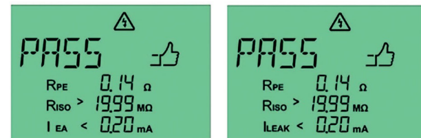
Fig. 26: Bestået måling med den alternative lækstrømsmetode (til venstre) og differential strømsmetode (til højre) for en enhed med beskyttelsesklasse I
