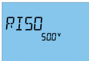
Fig. 4: Indstilling af målespænding R ISO
