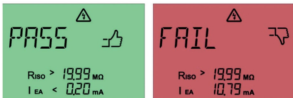
Fig. 35: Bestået berøringsstrømmåling (til venstre) og ikke-bestået berøringsstrømmåling (til højre) med erstatningsafledningsstrømmetoden
