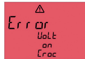
Fig. 61: Spænding på metal dele af testobjektet
