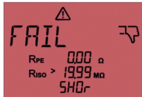
Fig. 48: Mislykket måling. "SHORT" vises på displayet. Kortslutning mellem L og N
