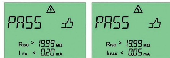
Fig. 36: Bestået måling med erstatningsafledningsstrømmetoden (til venstre) og differensstrømmetoden (til højre) på et apparat med beskyttelsesvurdering II
