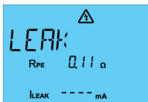
Fig. 59: Måling af beskyttelseslederstrøm på et 3-faset apparat
