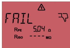
Fig. 41: Måling afbrudt; fortsæt eller afbryd måling i henhold til situationen
