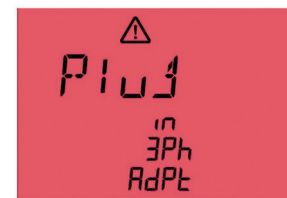
Fig. 62: Tilslut aktiv 3-faset måleadapter
