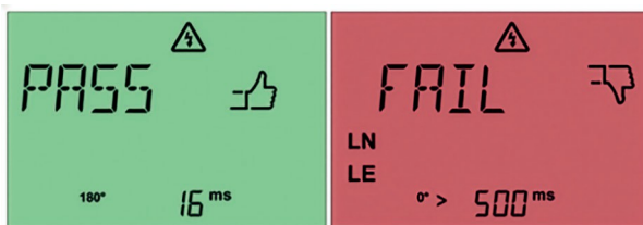
Fig. 53: Bestået RCD-måling (til venstre) og ikke-bestået måling (til højre)
