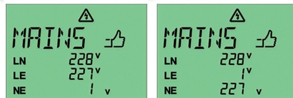
Fig. 10: Bestået måling, måleværdier inden for toleranceområdet
