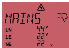
Fig. 11: Mislykket måling, målte værdier uden for toleranceområdet
