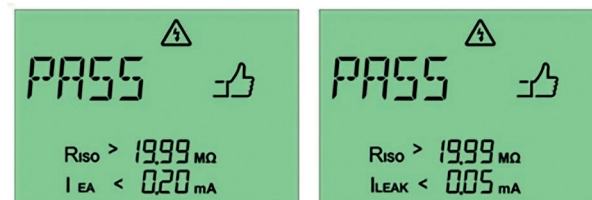
Fig. 36: Bestået måling med den alternative lækstrømmetode (til venstre) og differentialstrømmetode (til højre) for en enhed med beskyttelsesklasse II
