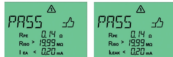
Fig. 26 : Mesure réussie avec la méthode alternative du courant de fuite (à gauche) et la méthode du courant différentiel (à droite) pour un appareil avec indice de protection I
