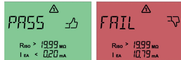
Fig. 35 : Mesure du courant de contact réussie (à gauche) et mesure du courant de contact échouée (à droite) avec la méthode alternative de mesure du courant de fuite
