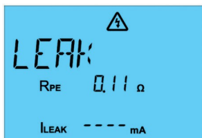
Fig. 59 : Mesure du courant du conducteur de protection dans un appareil triphasé
