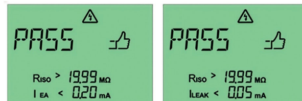
Fig. 36 : Mesure réussie avec la méthode du courant de fuite de remplacement (à gauche) et la méthode du courant différentiel (à droite) sur un appareil de Classe de protection II
