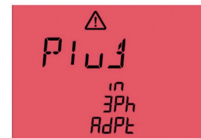
Fig. 62 : Brancher l'adaptateur de mesure triphasé actif
