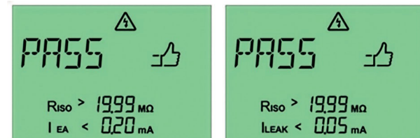
Fig. 36 : Mesure réussie avec la méthode alternative du courant de fuite (à gauche) et la méthode du courant différentiel (à droite) pour un appareil avec indice de protection II
