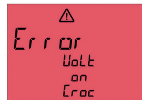
Fig. 61 : Tension sur les parties métalliques de l'objet testé
