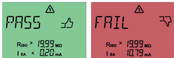
Fig. 35 : Mesure du courant de contact réussie (à gauche) et mesure du courant de contact échouée (à droite) avec la méthode du courant de fuite de remplacement
