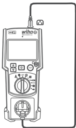
Fig. 38 : Raccordement de l'échantillon à l'appareil de mesure
