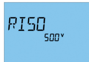
Fig. 4 : Réglage de la tension de mesure R_{50}
