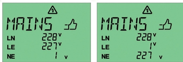
Fig. 10 : Mesure réussie, valeurs mesurées dans la plage de tolérance
