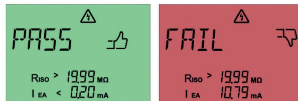
Fig. 35: Misurazione della corrente di contatto superata (a sinistra) e misurazione della corrente di contatto non superata (a destra) con il metodo della corrente di dispersione alternativa
