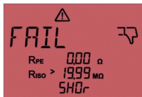
Fig. 48: Misurazione non riuscita. Sul display compare la scritta "SHOR".
