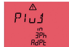
Fig. 62: Collegare l'adattatore di misura trifase attivo
