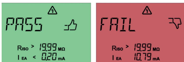
Fig. 35: Misurazione della corrente di contatto superata (a sinistra) e non superata (a destra) con il metodo della corrente di dispersione sostitutiva
