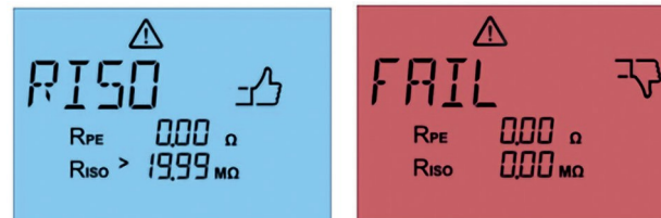
Fig. 44: Misurazione superata della resistenza di isolamento (a sinistra) e misurazione non superata (a destra)
