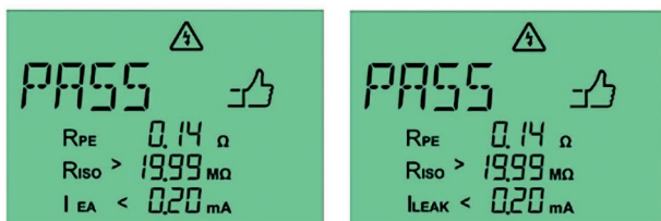
Fig. 26: Misurazione superata con il metodo della corrente di dispersione sostitutiva (a sinistra) e con il metodo della corrente differenziale (a destra) su un apparecchio della classe di protezione I
