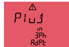
Fig. 62: Collegare l'adattatore di misura trifase attivo
