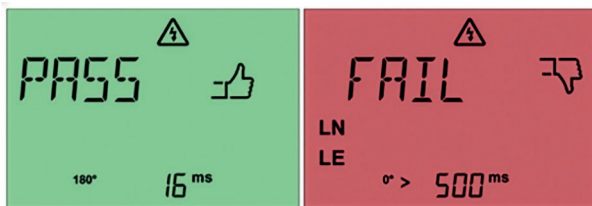
Fig. 53: Misurazione RCD superata (a sinistra) e misurazione non superata (a destra)
