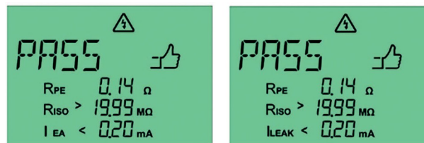
Fig. 26: Misurazione superata con il metodo alternativo della corrente di dispersione (a sinistra) e il metodo della corrente differenziale (a destra) per un dispositivo con grado di protezione I
