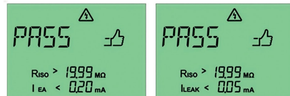
Fig. 36: Misurazione superata con il metodo alternativo della corrente di dispersione (a sinistra) e il metodo della corrente differenziale (a destra) per un dispositivo con grado di protezione II
