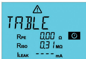
Fig. 21: Misurazione interrotta; controllare il valore misurato e, se necessario, continuare o interrompere
