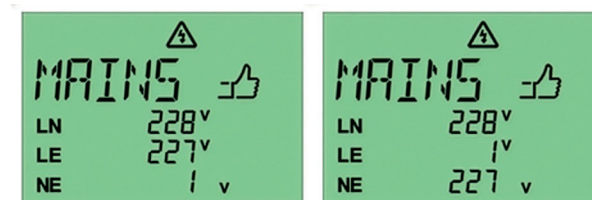
Fig. 10: Misurazione superata, valori misurati entro il campo di tolleranza
